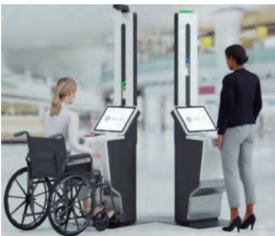
Existen diferentes modelos de máquinas de información, venta o recogida de número de orden ya completamente accesibles y que permiten su uso frontal a todas las personas, pantallas táctiles, locución, pictogramas, braille, mayor audición, sistemas intuitivos de funcionamiento...
