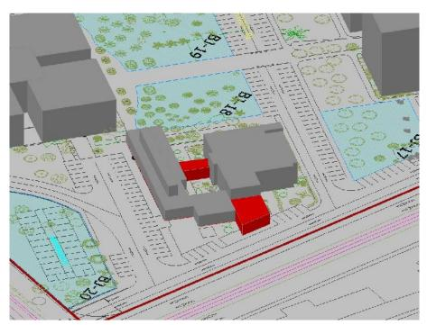
Mediante estos volúmenes se amplía el volumen del BJ-14. La superficie de ambos volúmenes es de 164.32 m² en una planta
